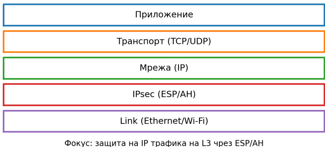
Фигура 4. Мястото на IPsec в мрежовия стек: защита на IP трафика на ниво 3
